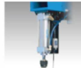
鋼件彎曲自動偵測器，在發生鋼材變形時的自動停止裝置，可避免因鋼件變形連帶造成機器與刀具的損壞。
