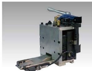
專利線軌式夾爪，利用線性滑軌做傳動，鋼性佳、作動順暢，提升抗扭矩能力，附脫料偵測(選配)，以提高自動化操作的安全性。
