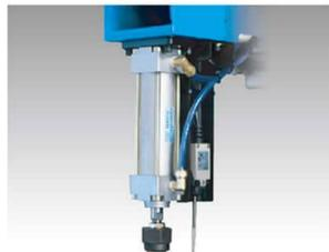
鈹件彎曲自動偵測器，在發生鈹材變形時的自動停止裝置，可避免因鈹件變形連帶造成機器與刀具的損壞。
